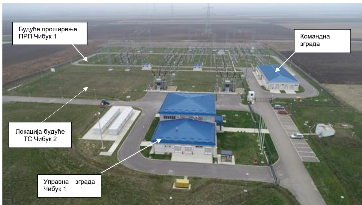
Слика 7-1 Планирани просторни распоред ТС „Чибук 2“ и проширеног ПРП „Чибук 1“
